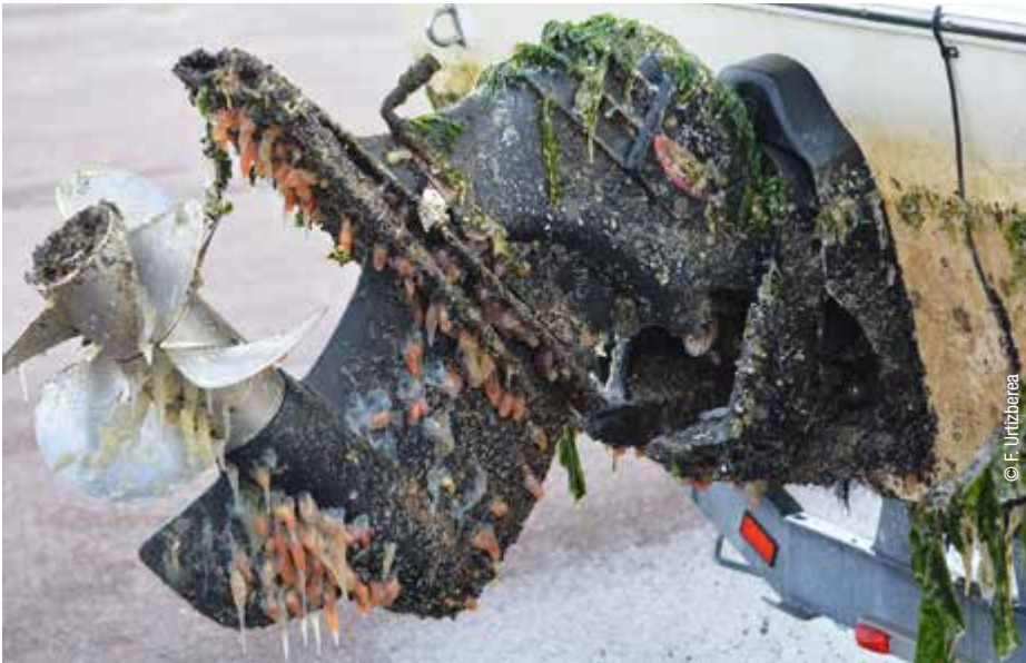
Figure 1. Biofouling sur un moteur de bateau de plaisance.
