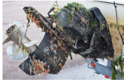
Figure 1. Biotouting sur un moteur de bateau de plaisance.
