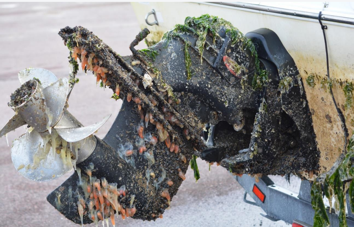
Biofouling sur moteur d'un bateau de plaisance. © F. Urtizbera
