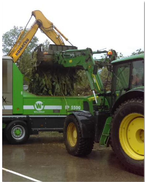
Figure n°8 - chargement des tiges de renouées asiatiques dans le broyeur à la déchetterie de Thoraise (25) (M. Bergeron - SYBERT).
