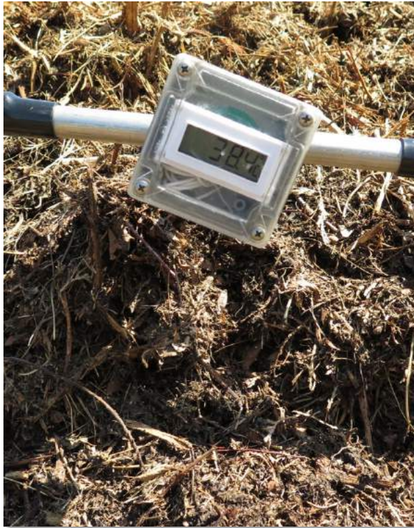
Figure n°15 - sonde mesurant la température en un point d'andain (M. Vuillemenot).
